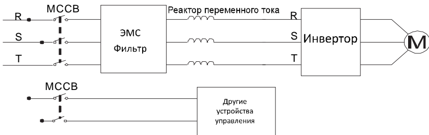
Рисунок 4.13. Электромонтаж входной силовой цепи
