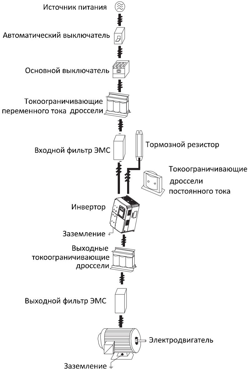
Рисунок 4.1. Подсоединение внешних устройств
