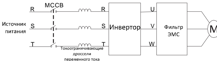
Рисунок 4.14. Электромонтаж силовой цепи электродвигателя
