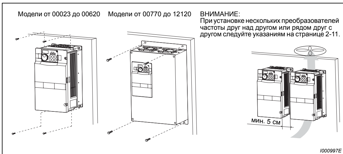
Рис. 2-6: Установка на монтажной плате шкафа управления
