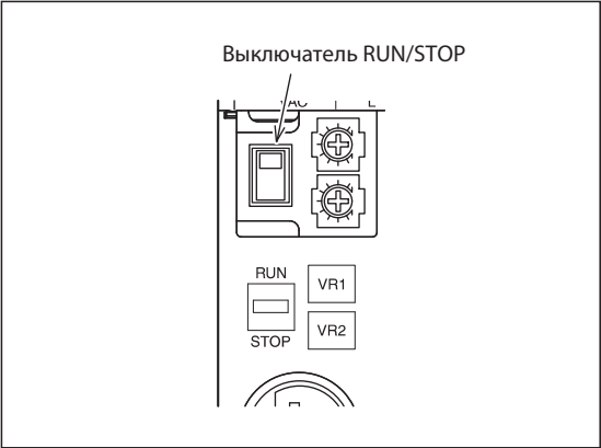
Рис. 7-5: Если выключатель "RUN/STOP" находится в верхнем положении, выполняется программа контроллера (режим "RUN"). В нижнем положении программа не выполняется (режим "STOP").
