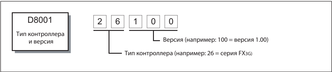
Рис. 2-8: Указание версии базового модуля в специальном регистре D8001
