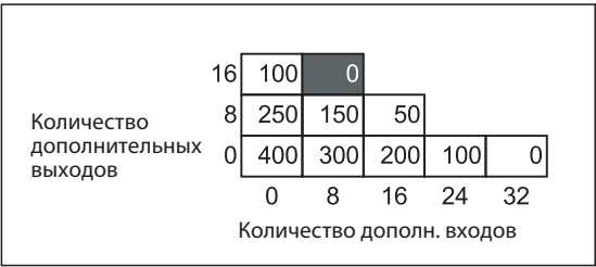
Рис. 2-20: Если модули расширения подключаются к источнику управляющего напряжения, его мощность полностью исчерпывается.
