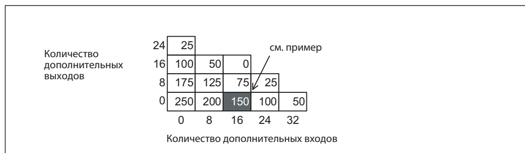
Рис. 2-24: Диаграмма резервов тока для модулей расширения FX3U-32E□-E□/UL
