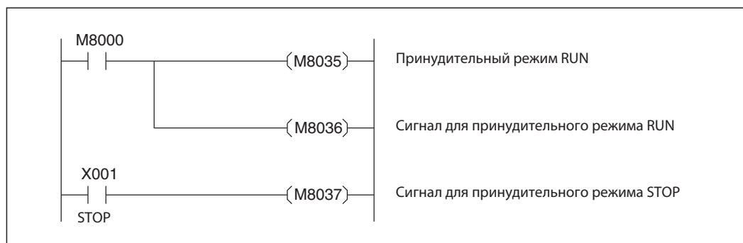
Рис. 6-24: Программа для запуска и останова контроллера с помощью двух входов
