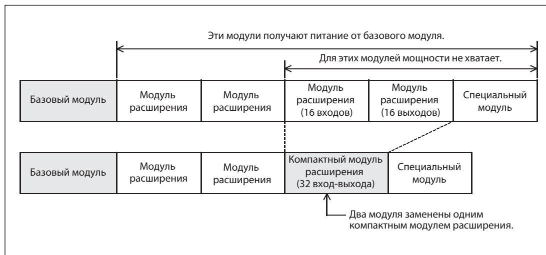
Рис. 2-23: Пример применения компактного модуля расширения
