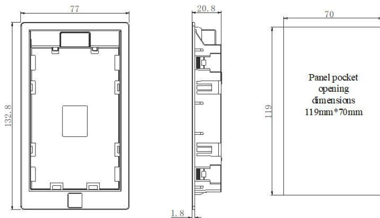
AC10 Зовнішня кишеня для дворядкової клавіатури та монтажні розміри
