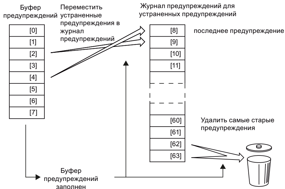
Изображение 9-4 Перемещение устраненных предупреждений в журнал предупреждений
