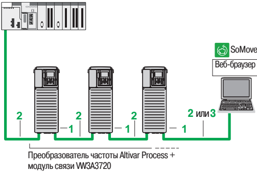
Пример подключения преобразователей частоты по сети EtherNet/IP
