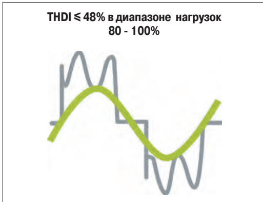
Altivar Process: искажение кривой тока, потребляемого из сети
