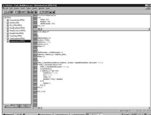
Пример программы на языке структурированного текста
