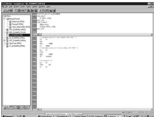
Пример программы на языке списка инструкций
