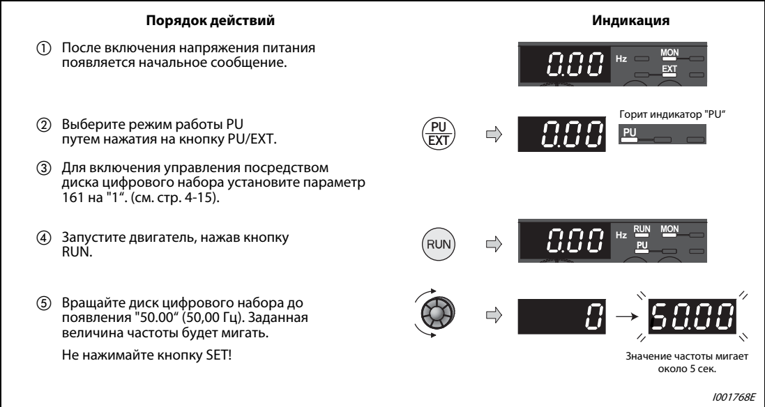
Рис. 5-13: Настройка выходной частоты посредством панели управления
