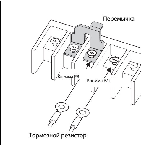
Рис. 3-19: Подключение тормозного резистора к клеммам P/+ и PR преобразователей частоты типов FR-E740-120 и FR-E740-300
