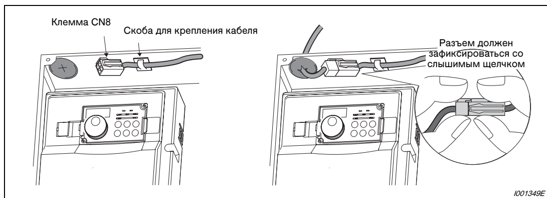
Рис. 3-38: Подключение клеммы CN8
