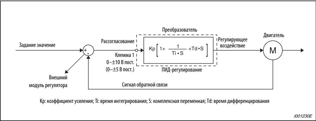
Рис. 6-235: Конфигурация системы для пар. 128 = 10, 11 (использование задания в виде рассогласования)
