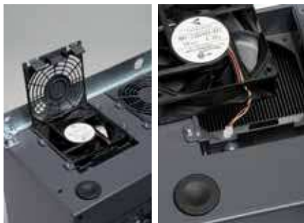
Удобство обслуживания, продуманное до мелочей: легко доступные и быстро заменяемые вентиляторы
