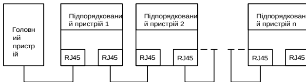
Рисунок А-5 Електрична схема підключення лінійної топології мережі
