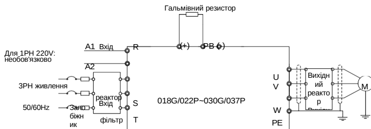
Рисунок 4-7 Схема підключення головного кола для моделей 018G/022P-030G/037P моделей
