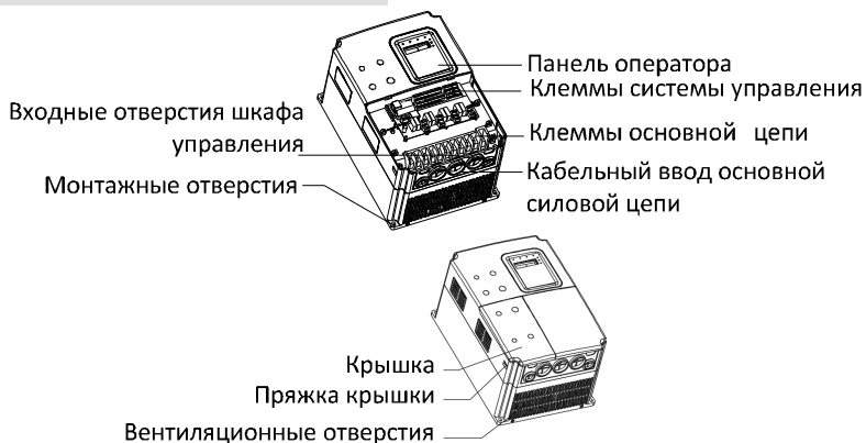
Рисунок 1.3. Наименования частей преобразователя (менее 18.5кВт)
