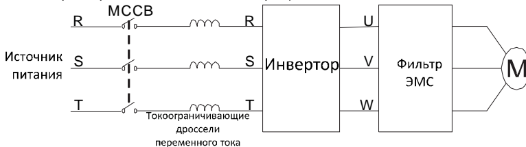
Рисунок 4.17. Электромонтаж силовой цепи электродвигателя
