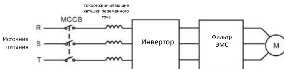
Рисунок 4.14. Электромонтаж силовой цепи электродвигателя
