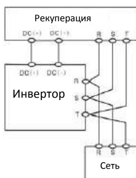
Рисунок 4.15. Электромонтаж цепи рекуперации
