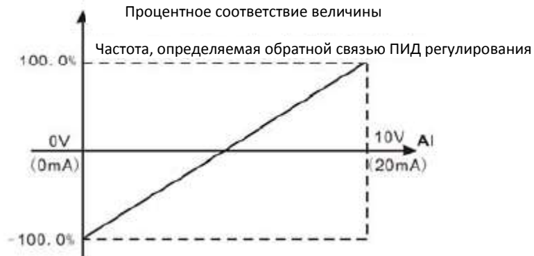
Рисунок 6.14. Отношение между сигналом аналогового входа AI и соответствующей величиной.
