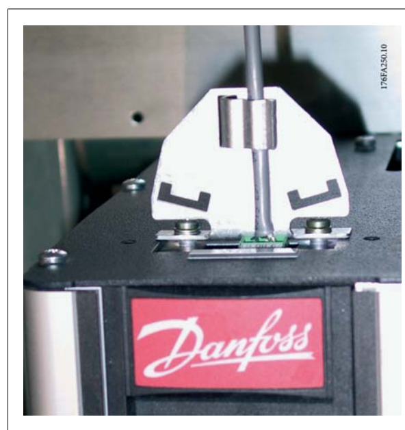
Рисунок 6.36: Подключение шины fieldbus сверху.
