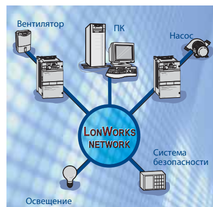
Преобразователь частоты FR-F 740/F746 в сети LonWorks
