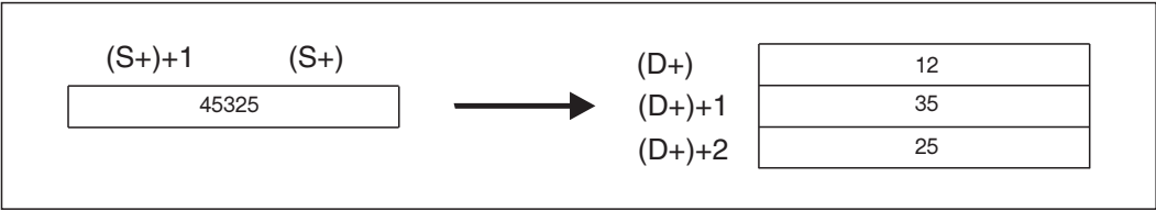
Рис. 7-157: Пример применения команды DSTOH: 45325 секунд соответствуют 12 часам, 35 минутам и 25 секундам.
