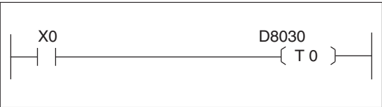
Рис. 8-12: Таймер со значением уставки, которая может изменяться с помощью потенциометра VR1.
