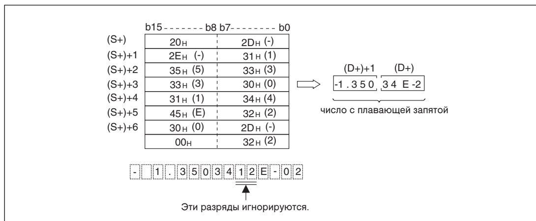
Рис. 7-73: При экспоненциальном представлении преобразуются 6 разрядов целой и десятичной части.
