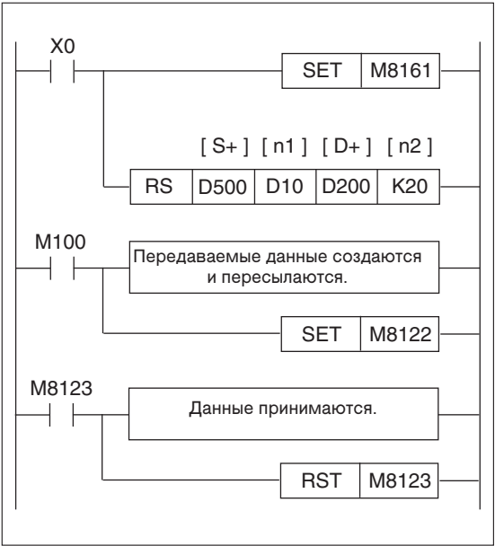
Рис. 7-31: Пример программирования RS-инструкции
