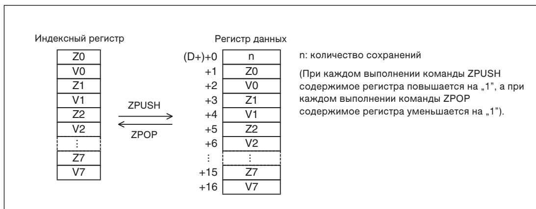
Рис. 7-51: Действие команд ZPUSH/ZPOP без вложения
