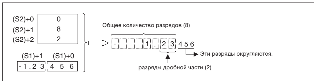
Рис. 7-59: Остальная дробная часть в строковой величине не появляется, однако, учитывается и округляется.
