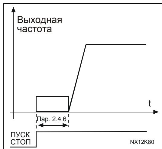
Рис. 1-13. Время торможения постоянным током при пуске
