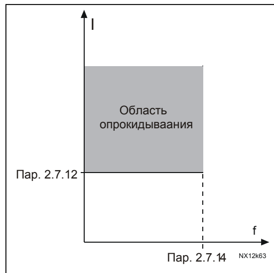
Рис. 1-20. Настройка характеристик блокировки
