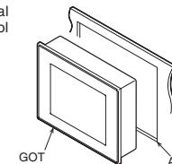
③ Enganche el gancho del adaptador de fijación (suministrado) a las aberturas laterales de fijación del terminal GOT y apriete los tornillos de fijación hasta que el GOT quede inmovilizado.
