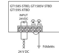
A feszültségesek elkerüléséhez használjon 2 mm<sup>2</sup> vagy vastagabb keresztmetszűt kábeleket és a sorkapocs-csavarokat húzza szorosra 0,5-0,8 NM nyomatékkel.
