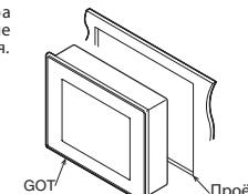
③ Вставьте крючок крепежного зажима (входит в комплект) в монтажное отверстие на панели оператора и затяните винт, чтобы зафиксировать панель. Установив все входящие в комплект крепежные зажимы, затяните их винты моментом 0,36–0,48 Нм.
