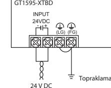
Gerilim düşümünü önlemek için 2 mm<sup>2</sup> veya daha kalın kablo kullanın ve terminal vidalarını 0,5 – 0,8 Nm torkla iyice sıkın. Besleme bağlantısı için, M3 vidaları için piyasada bulunan kaplo pabuçlarını kullanın (aşağıdaki şekilde bakın).
