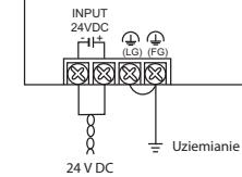
Celem uniknięcia spadek napięcia należy używać kabli o przekroju 2 mm<sup>2</sup> lub większym. Porządko dokreć śruby z momentem 0,5 do 0,8 Nm. Do podłączenia napięcia zasilającego należy stosować dostępne w handlu zakończenia przewodów przeznaczone do śrub M3 (zob. poniższy rysunek).
