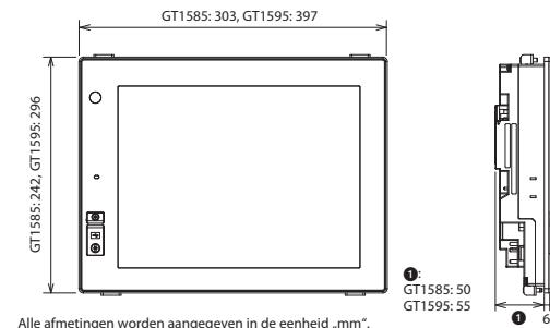
Alle afmetingen worden aangegeven in de eenheid „mm“.
