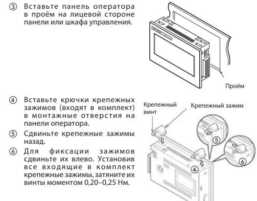
После установки снимите с экрана панели защитную пленку.
