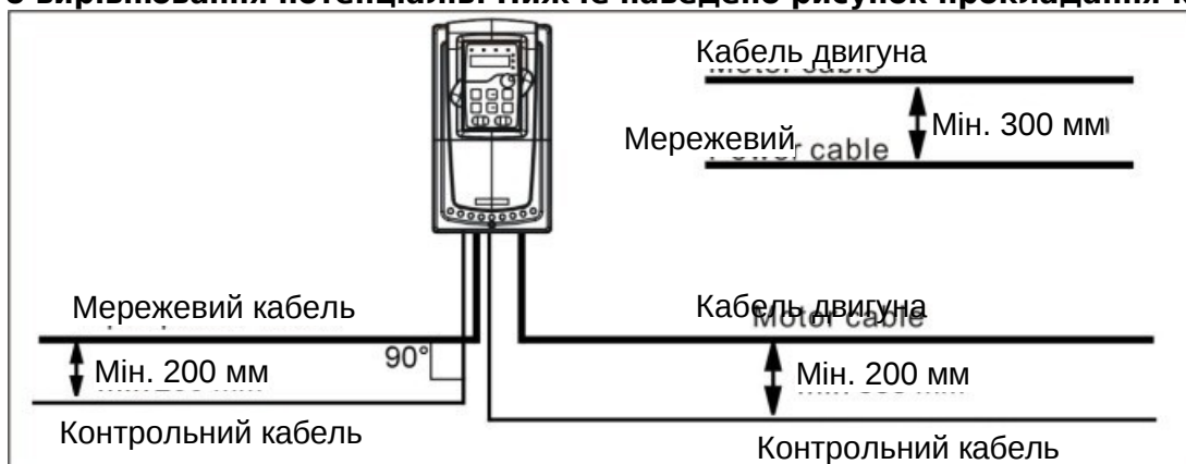
Рис. 5-1. Схема прокладання кабелів
