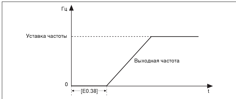
Рис. 12-26: Торможение пост. током перед запуском
